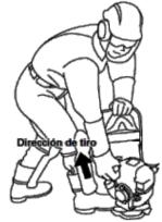
Tire un poco de la empuñadura del arrancador hasta notar resistencia y luego tire con fuerza
